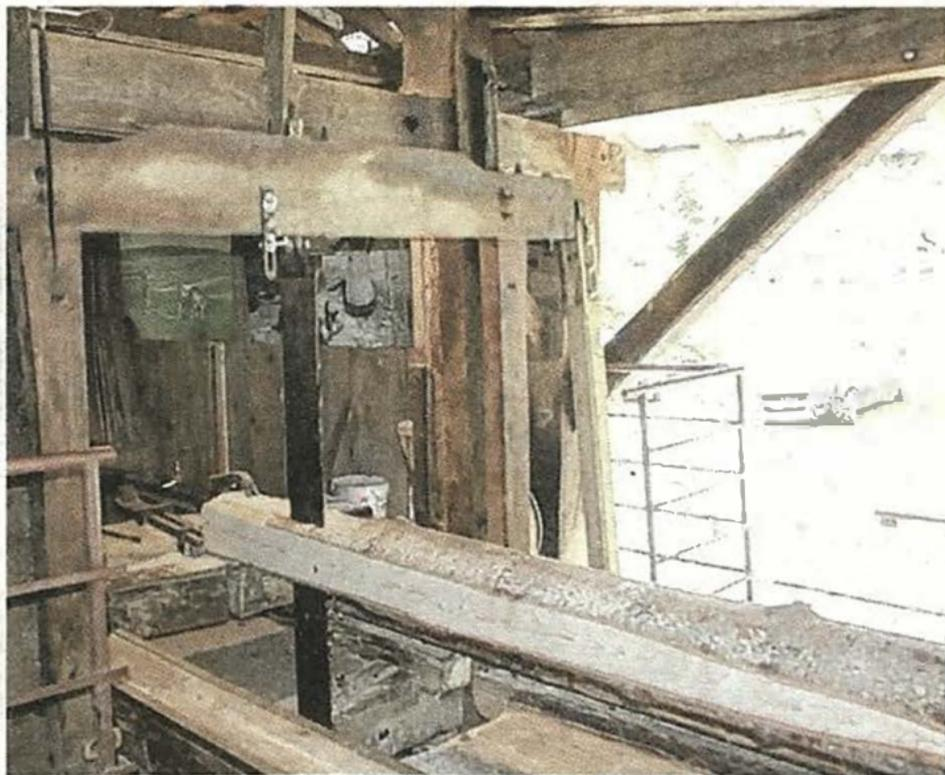
Dimanche 11 mai à Lepuix, le soleil a mis en valeur la scierie communale, ouverte aux visites et à la démonstration de sciage. L'arrivée d'eau était à un niveau bas, mais la grande roue à augets de 4,50 mètres de diamètre a pu actionner la scie, qui s'est attaquée à une bille de sapin. Une demi-heure était nécessaire pour tirer une planche de 6 mètres. De nombreux marcheurs et randonneurs ont fait une pause pour admirer ce patrimoine vivant.
